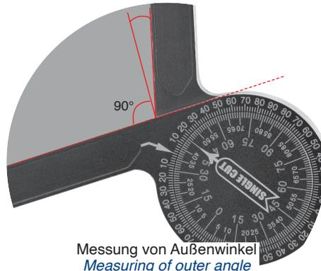
Messung von Außenwinkel
